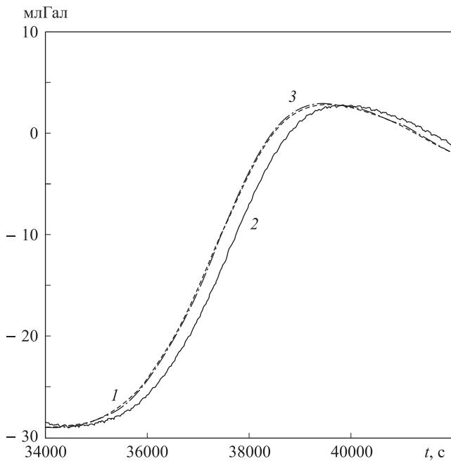
Рис. 4. Иллюстрация восстановления сигнала после гравиметра: 1 — «полезный сигнал», 2 — показания гравиметра, 3 — восстановленный сигнал
