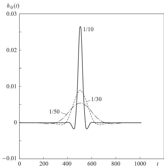
Рис. 2. Весовые функции фильтра низких частот
