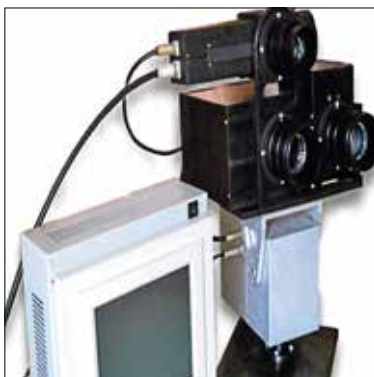
Рис. 4. Оптический модуль оптико- радиофизического комплекса для эксперимента «Диагностика»
