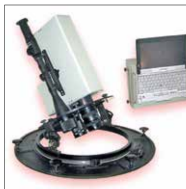
Рис. 2. Летный образец СФК с системой пространственного сканирования для эксперимента «Гидроксил»
