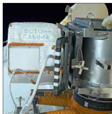
Рис. 3. Блок внешних датчиков «Фотон-гамма» для эксперимента «Молния-гамма» в открытом космосе
