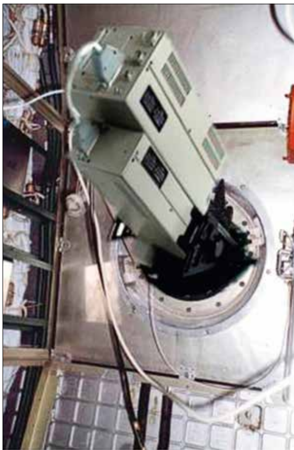
Рис. 1. Бортовая микропроцессорная видео-фотометрическая система ВФС-ЗМ, установленная на иллюминаторе служебного модуля МКС
