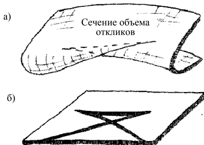
Рис. 5. Объем откликов с изображением двух сечений этого объема, соответствующих двум сечениям бифуркационного множества (а), фигура «ласточкин хвост» (б)
