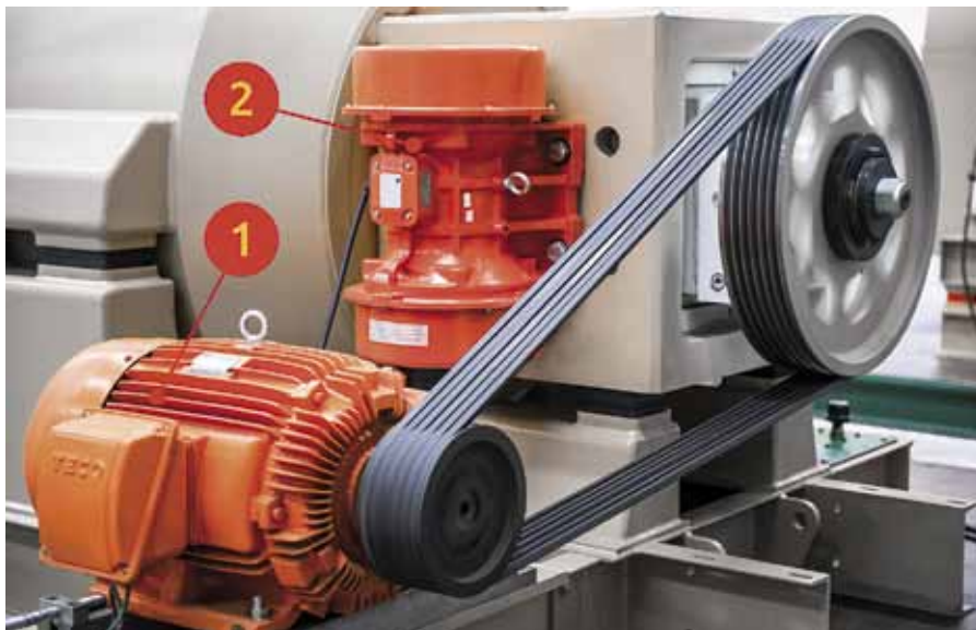
Рис. 4. Приводной электродвигатель (1) и один из вибромоторов (2)
