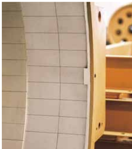
Рис. 3. Все поверхности центрифуги, подверженные абразивному воздействию, покрыты алюмооксидной керамической плиткой
