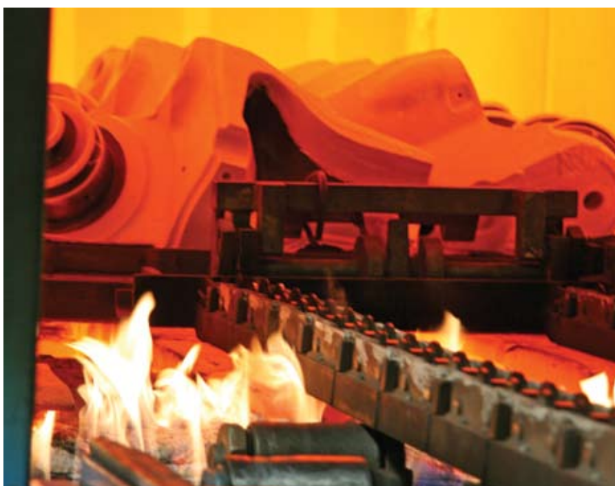
Рис. 1. Лапы трехшарошечных долот на выходе из печи химико-термической обработки перед закалкой в масло
