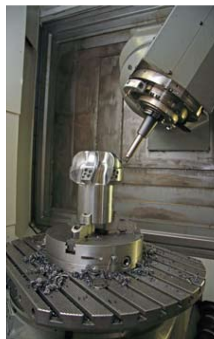
Рис. 3. Фрезерование и сверление корпуса алмазного долота на 5-координатном станке с ЧПУ
