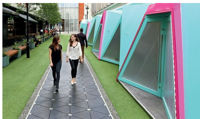
Рис. 7. Тротуарная плитка Пэвджен (Pavegen). Лондон. Автор технологии Л. Кэмболл-Кук
