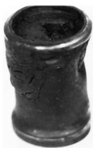
Рис. 5. Втулка с заполненной внутренней поверхностью
