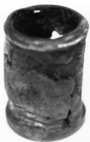
Рис. 4. Втулка с заполненной наружной поверхностью
