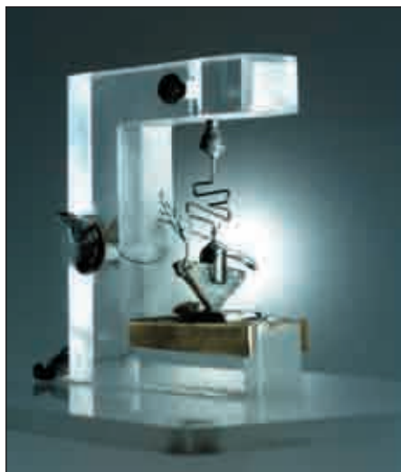
Рис. 23. Точечный транзистор Бардина-Браттейна
