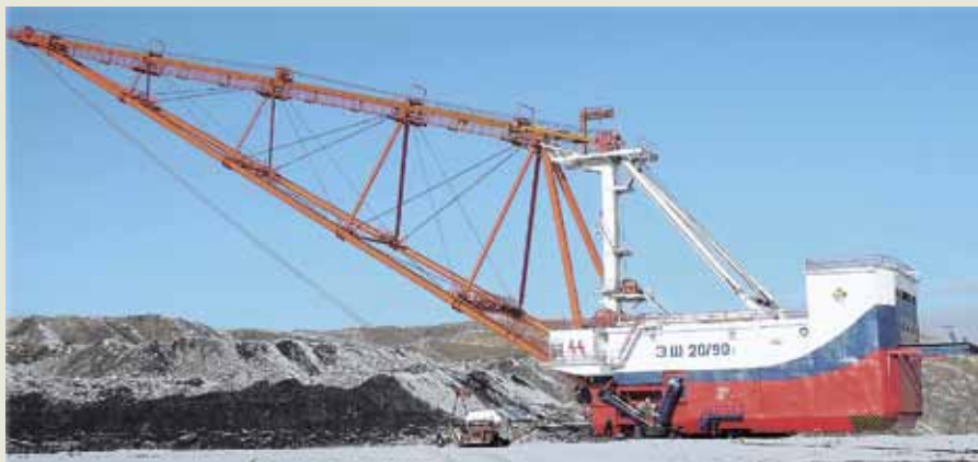
Рис. 11. Разрез «Тугнуйский». Экскаватор ЭШ-20/90 № 44. Внедрение вентильно-индукторных двигателей дало следующие эффекты: увеличение производительности на 18%; снижение удельного расхода электроэнергии на 57%; установленная мощность электрооборудования уменьшена в 2,5 раза; КТГ увеличен на 1,3%
