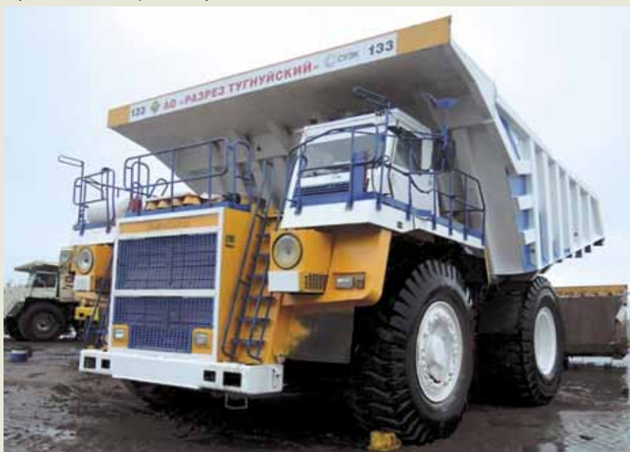
Рис. 12. Разрез «Тугнуйский». Автосамосвал БелАЗ грузоподъемностью 130 т. Полученные эффекты: рост средней скорости на коротком плече – на 16% и на длинном – на 26%; удельный расход топлива снижен на 5%. Наблюдения водителей: плавно трогается с места; быстрее набирает скорость; вспомогательная тормозная система работает безотказно и плавно; отсутствие щеточного механизма позволяет существенно снизить время ежедневного и планового обслуживания
