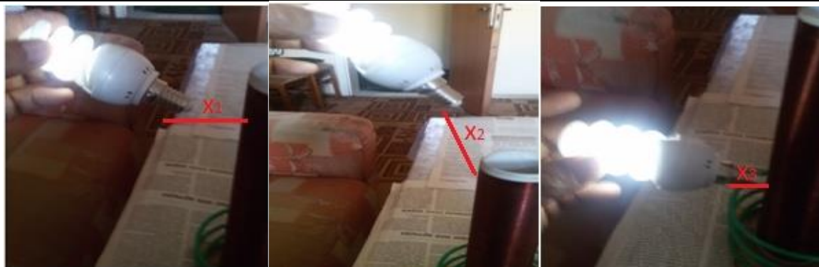
Рис. 4 Беспроводная передачи эл. энергии трансформатором Тесла.
