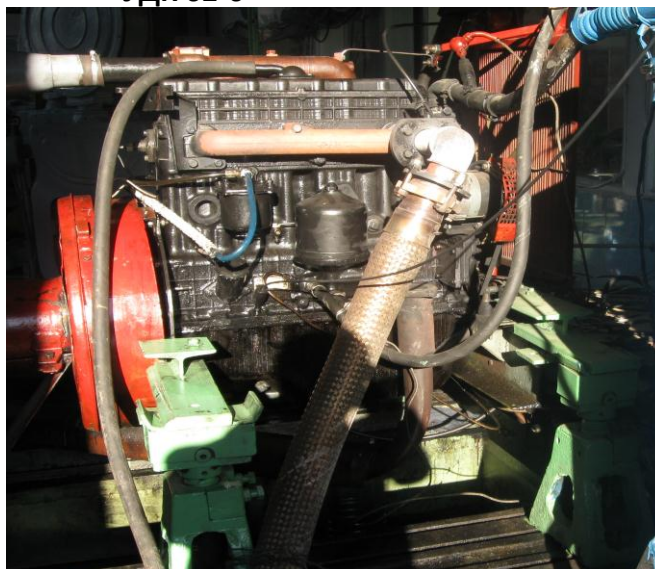
Рис. 3. Дизель для работы на топливе с добавкой рапсового масла
