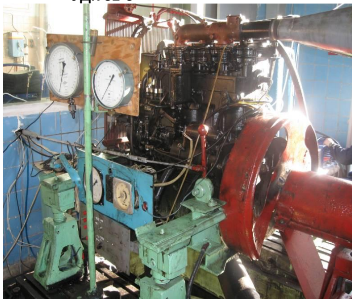
Рис. 2. Дизель Д-243, работающий на топливе с добавкой этанола
