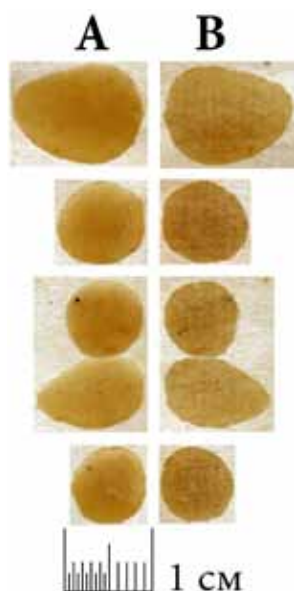
Илл. 23. Примеры восковых «отметок», полученных экспериментально на исторической бумаге (тряпичной) ручного отлива*. В столбце А представлены сканированные воспроизведения «отметок». Столбец В состоит из сканированных участков оборота бумажного листа, соответствующих восковым «отметкам» из столбца А (находящимся на его лицевой стороне): хорошо видна степень проникновения расплавленного воска в бумагу
