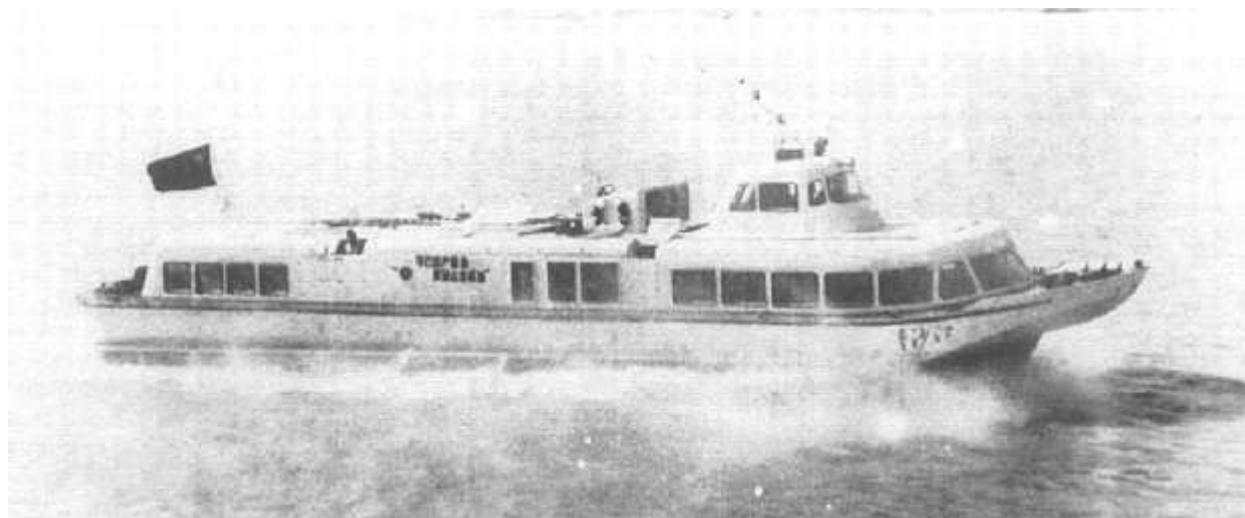
**Рис. 6. Первое китайское пассажирское судно с корпусом туннельного типа с жесткими боковыми скегами (на реке Джин Сах)**
