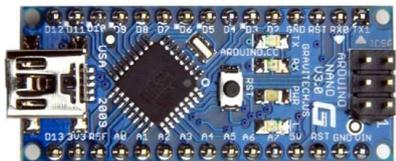
Рис. 6. Arduino Nano
