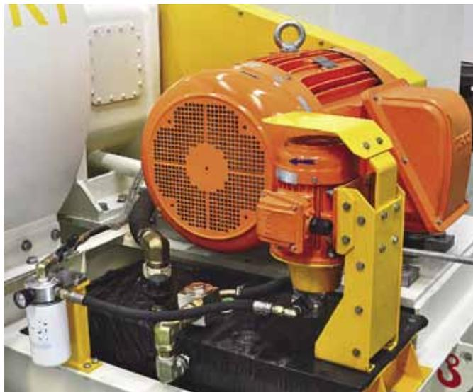
Рис. 5. Приводной электродвигатель и система смазки
