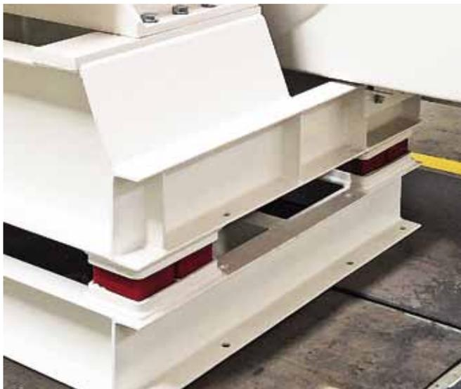
Рис. 4. Полиуретановые амортизаторы
