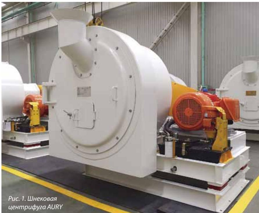
Рис. 1. Шнековая центрифуга AURY
