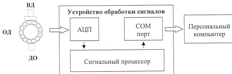
Рис. 1. Обобщенная структурная схема комплекса вибродиагностики:
