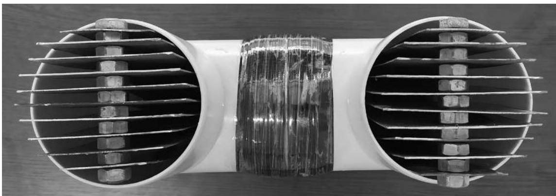
*Рисунок 2. Электролизер, вид изнутри сверху*
