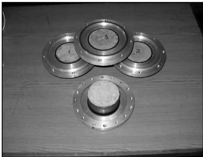
Рис. 3. Общий вид держателей с установленными в них пробами бетона
