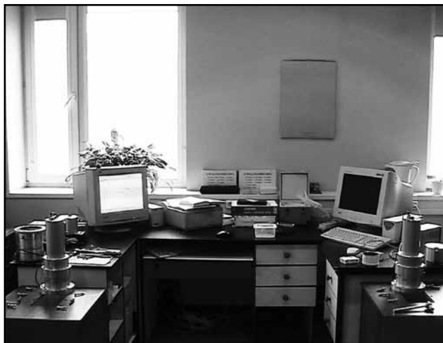
Рис. 1. Общий вид экспериментальных установок для определения коэффициента диффузии радона в материалах
