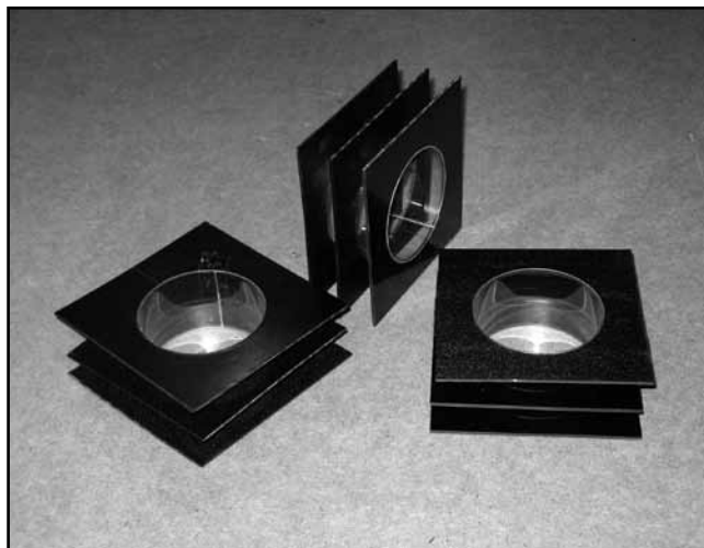
Рис. 2. Общий вид разборных форм для изготовления проб бетона
