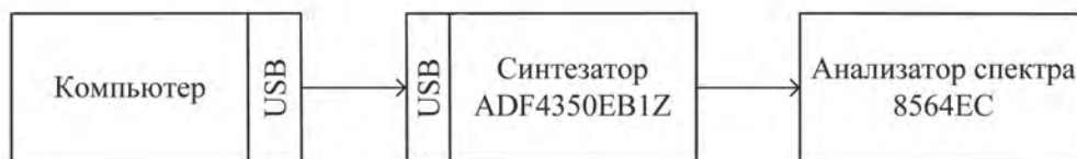
Рис. 2. Структурная схема измерительной установки
