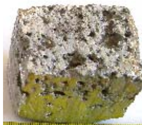
Рис. 1. Образец (40×35×35 мм) из пеноалюминия марки А7
