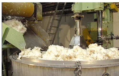
Рис. 2. Размол сырья для производства бумаги
