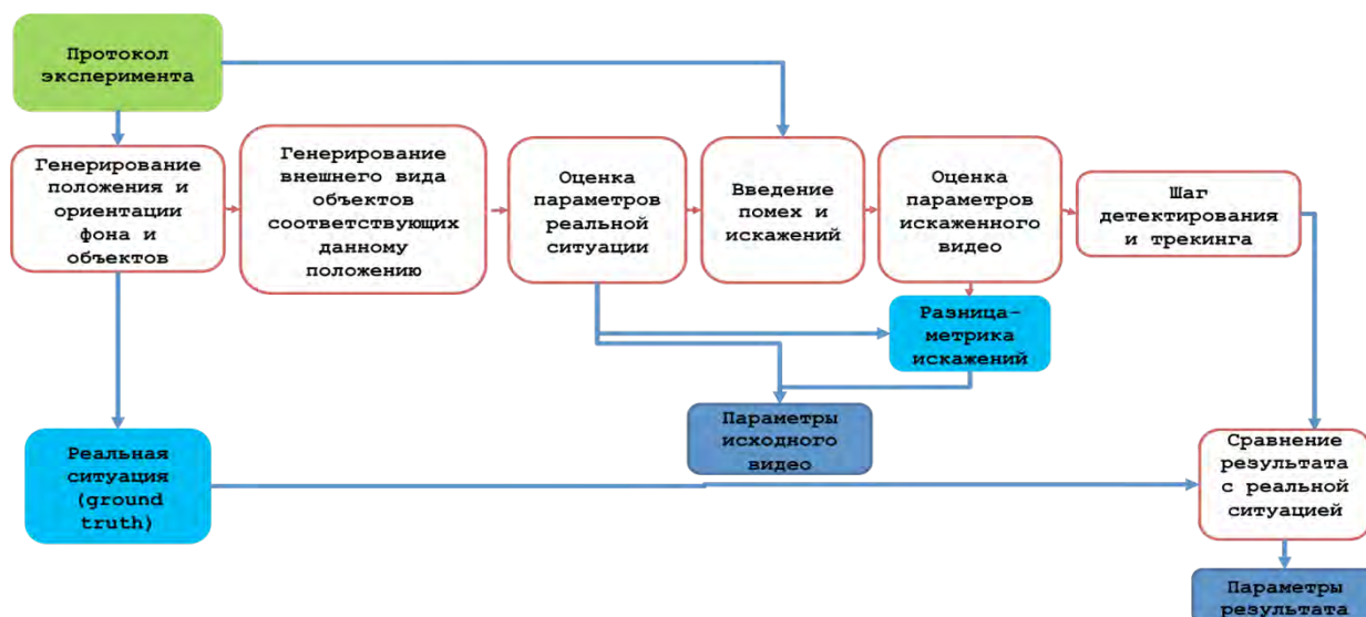
Рис. 7. Принцип работы системы оценки качества АОЭС НКМ
