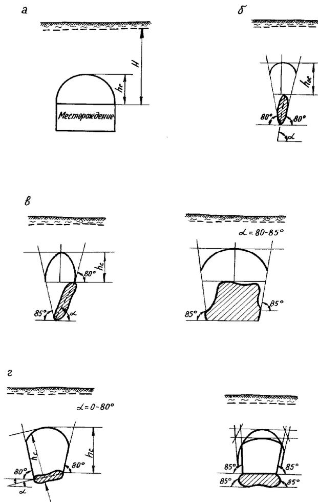
**Рис .2. Безопасное соотношение зон влияния пустот и глубины работ:** а - условие сохранности поверхности; б - для залежи с углом падения 85-90°; в - то же для угла падения 80-85°; г - то же для угла падения до 80°
