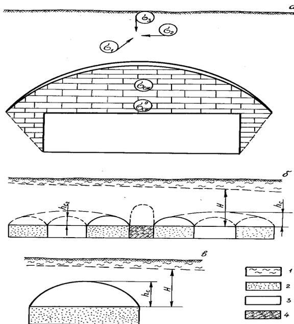
**Рис. 1. Раскройка массива на безопасные участки:** а - модель напряженности:  $\sigma_{1,2,3}$ ,  $\sigma_{сж}$ ,  $\sigma_0$  - напряжения в массиве, в нарушенных породах и в породах кровли выработки; б - разделение массива на безопасные участки: 1 - наносы; 2 - твердеющая закладка; 3 - изолированные пустоты; 4 - искусственный или рудный целик; H-глубина работ;  $h_{св}$  - высота зоны влияния выработки
