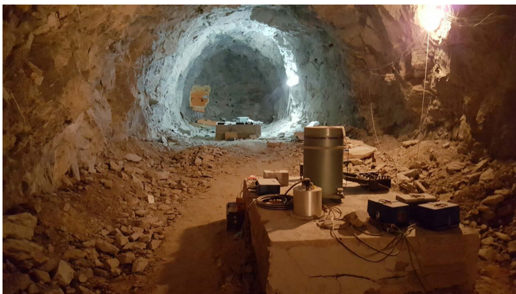
Рис. 6. Инструментальные постаменты лаборатории Северокавказской геофизической обсерватории, расположенной на отметке 4,1 км в боковой вырубке штольни „Вспомогательная“ БНО ИЯИ РАН [13]
