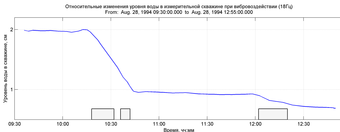
Рис. 1. Изменение уровня воды в скважине, связанное с вибровоздействием
