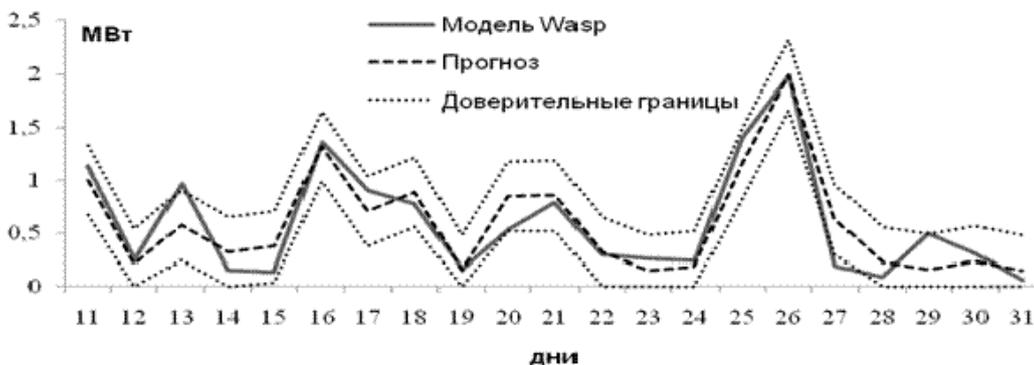
Рис. 2. Доверительный интервал прогнозируемой мощности ВЭС
