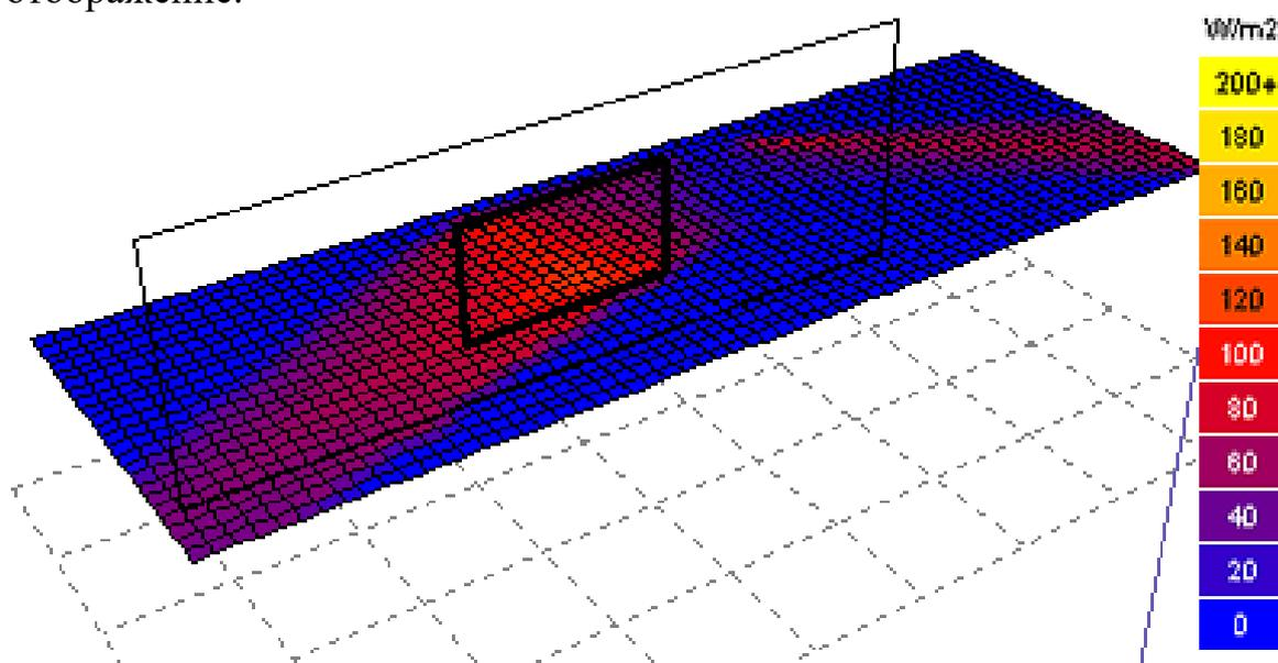
*Рисунок 12 - Влияние дополнительного омрачения от фиксированной обструкции на отображаемый потенциал затенения.*
