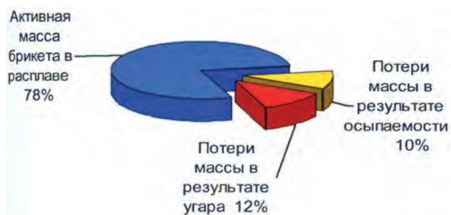
Рис. 6. Эффективность использования холоднопрессованных брикетов при плавке
