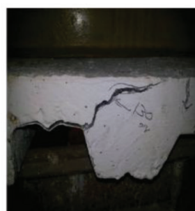
Fig. 5 (c) Longitudinal failure
