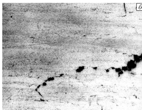
Рис. 14. Влияние термомеханической обработки на характер откольного разрушения сплава ВТ6 партий 1 и 2: сплав 2 (размер зерна d_g = 810 мкм), \times 14 (a); сплав 1 (размер зерна d_g = 14 мкм) (б), \times 14
