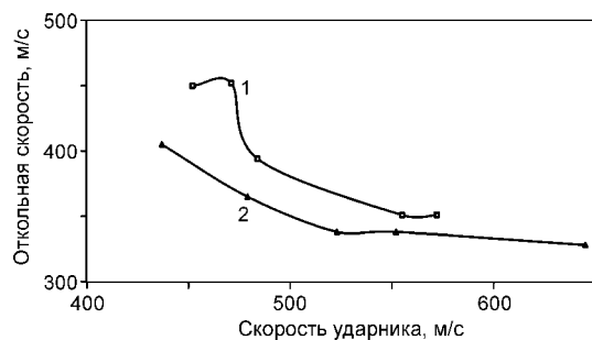
Рис. 15. Зависимость откольной скорости W от скорости ударника для титанового сплава ВТ6 партий 3 (1) и 4 (2). Содержание кислорода — 0.105 (1) и 0.198 % (2)
