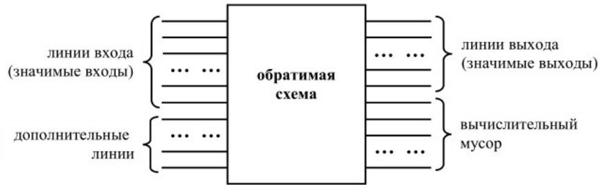
Рис. 10. Входы и выходы обратимой схемы
