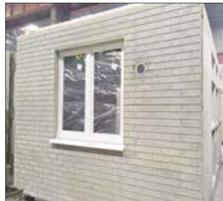
Рис. 20. Линия отделки объемных блоков
