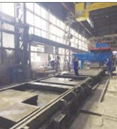
Рис. 21. Конвейерная линия производства стеновой панели
