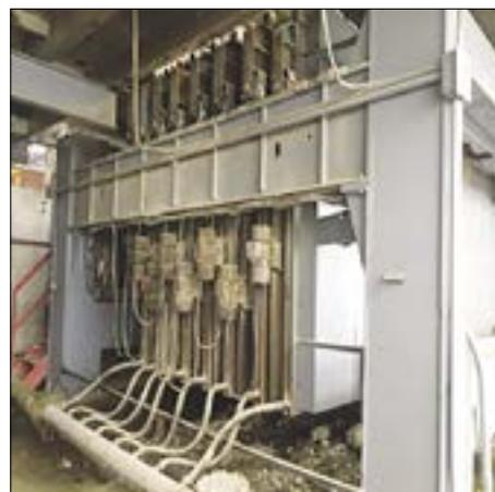
Рис. 23. Кассетная установка для производства перегородок
