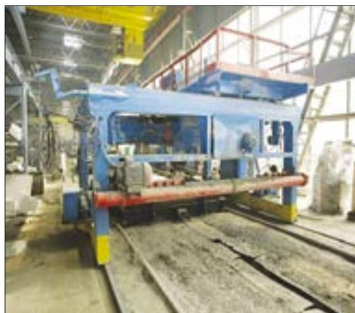
Рис. 22. Бетонукладчик конвейерной линии производства стеновых панелей СМЖ-166
