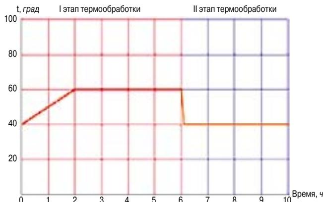
Рис. 18. График тепловой обработки объемных блоков
