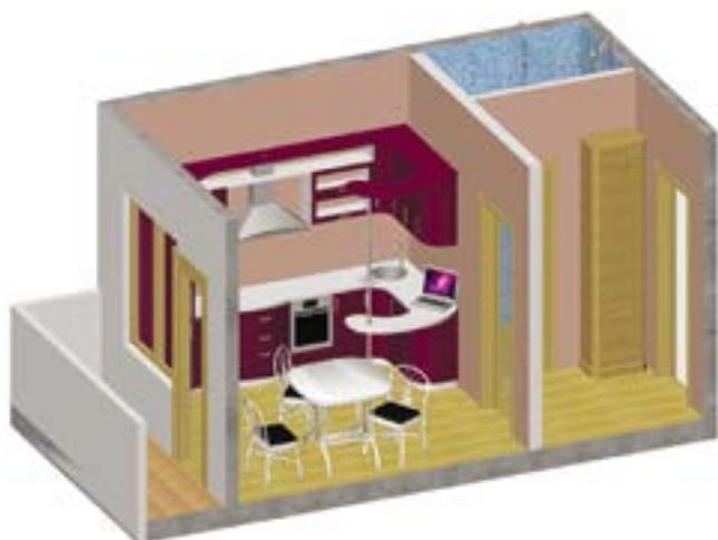
Рис. 7. Блок-комната с балконом объемно-блочного домостроения
