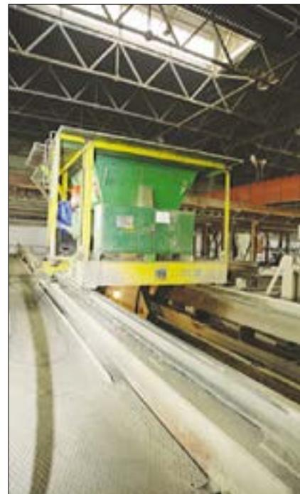
Рис. 16. Формование объемного блока
