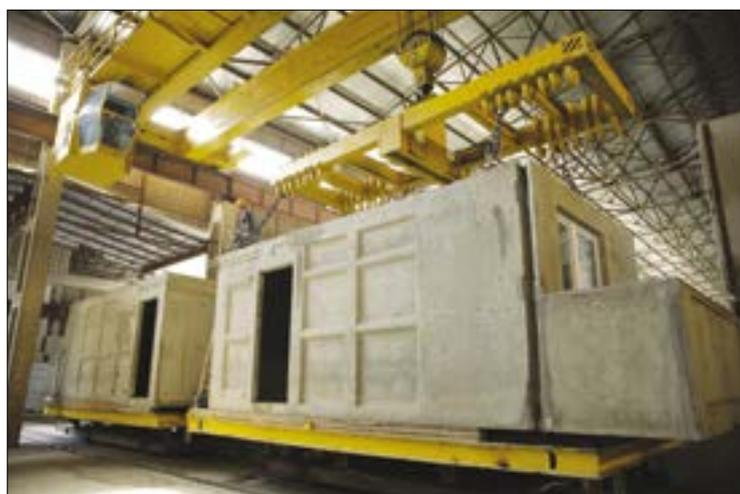
Рис. 8. Вывоз готового объемного блока на строительную площадку
