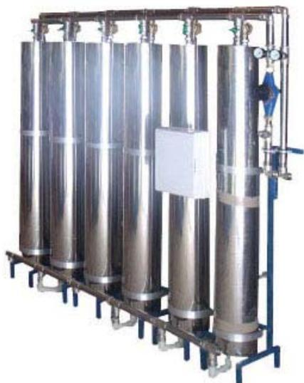
Рис. 5. Ультрафильтрационный блок производительностью 15–20 м<sup>3</sup>/ч
