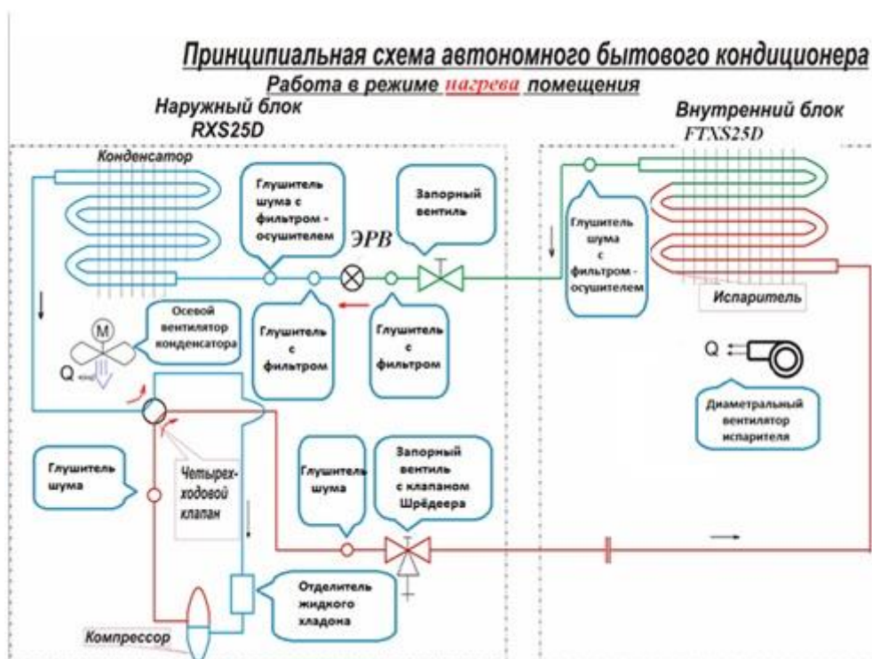
Рис. 3. Принципиальная схема автономного бытового кондиционера, работающего в режиме нагрева
