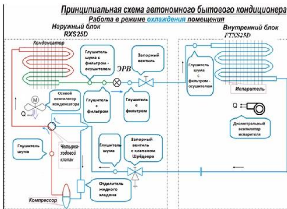
Рис. 2. Принципиальная схема автономного бытового кондиционера, работающего в режиме охлаждения помещения
