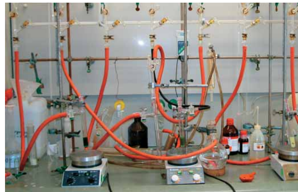
Магнитные мешалки (на переднем плане) используются для синтеза соединений при перемешивании и нагревании, вакуумная система (позади) – для соединений, требующих инертной атмосферы
