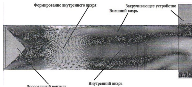
Рис. 8. Структура газового потока в вихревой трубе Fig. 8. Structure of the gas flow in the Vortex tube
