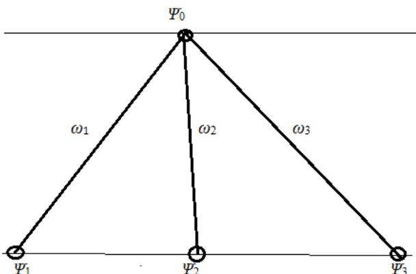
Рис. 1. Узел нормальной сети прямого распространения со смежными узлами нижестоящего среза.
