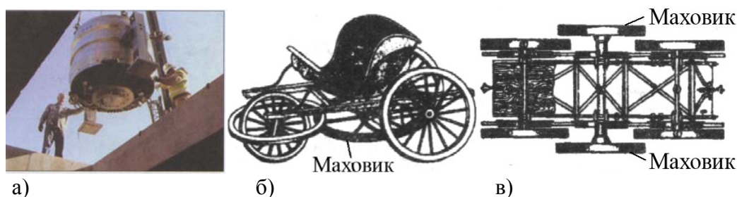
Рис. 1. а) маховичный двигатель (США); б) коляска Кулибина; в) гировоз Шуберского
