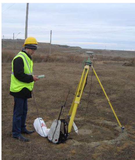
Рис. 3. Исследование сдвижения приборного массива на карьере «Варваринское» с помощью GPS
