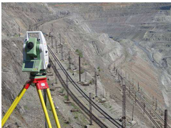
Рис. 1. Наблюдения с электронным тахеометром на карьере
