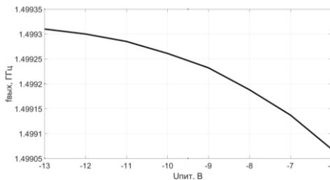
Рис. 9. Зависимость частоты генератора от напряжения питания
