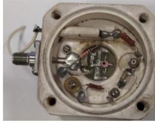
Рис. 2. Фото генератора со снятой крышкой со стороны активной части
