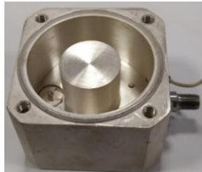
Рис. 3. Фото генератора со снятой крышкой со стороны коаксиального резонатора
