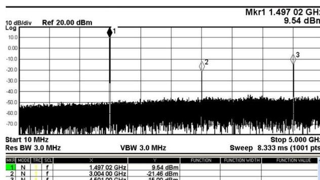
Рис. 10. Спектр выходного сигнала
