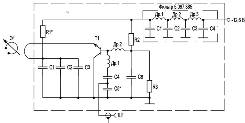
Рис. 1. Принципиальная схема генератора 1,5 ГГц
