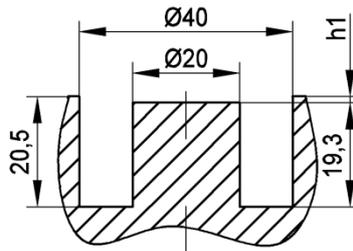
Рис. 4. Резонатор в разрезе с размерами
