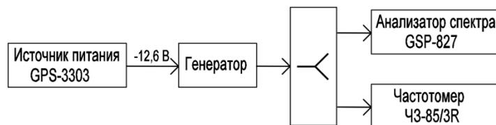
Рис. 7. Структурная схема измерительной установки
