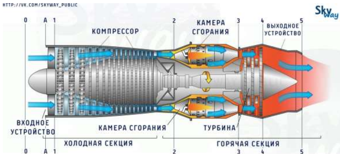
Рис. 3. Схема работы ТРД
