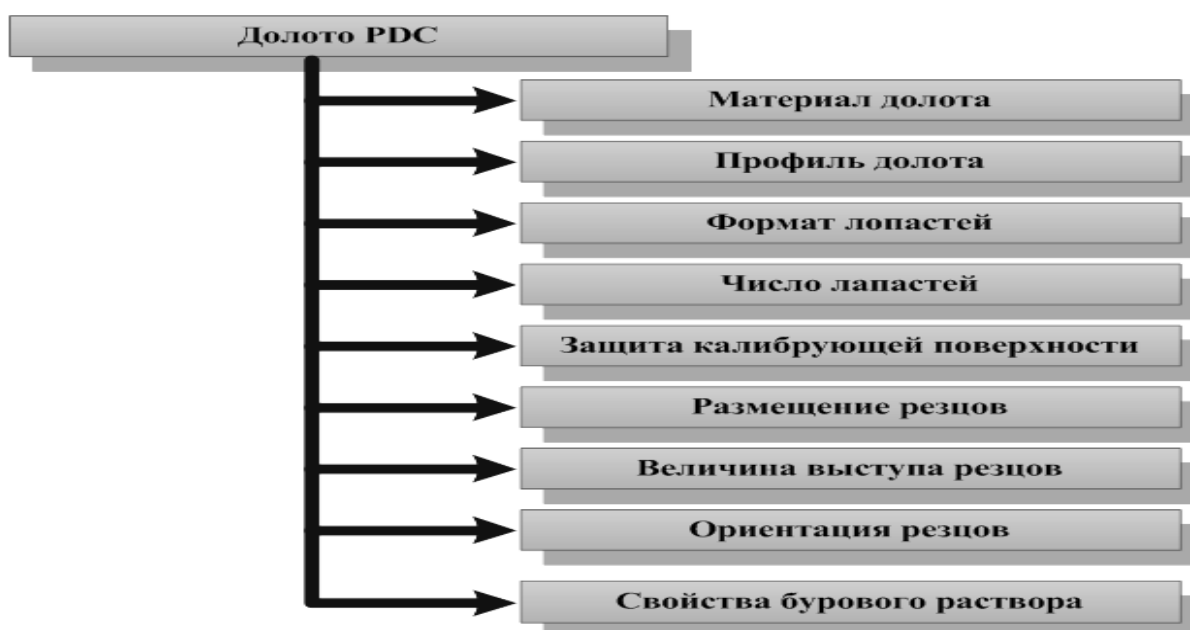
Рис. 9. Переменные, влияющие на эффективность долот PDC
