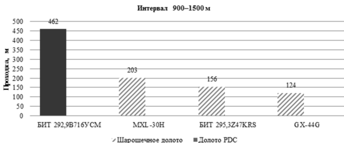
Рис. 7. Проходка на долото при бурении под техническую колонну для применяемых типов
