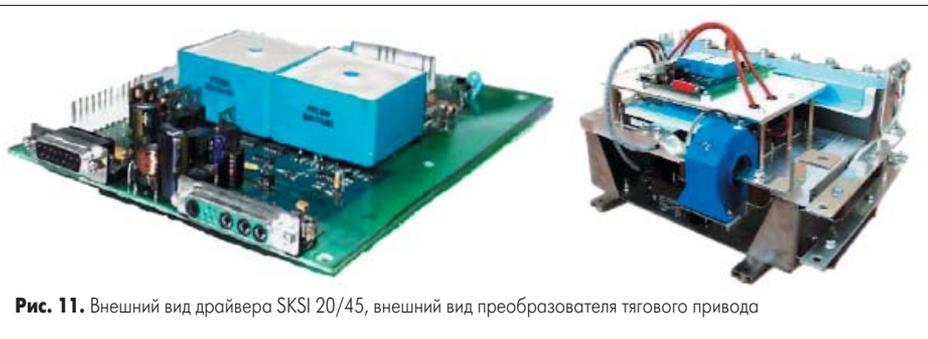
Рис. 11. Внешний вид драйвера SKSI 20/45, внешний вид преобразователя тягового привода
