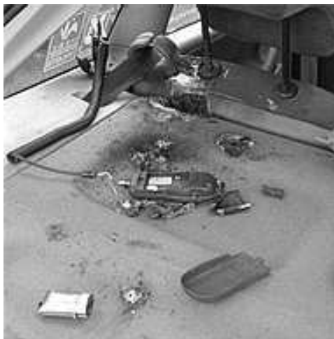
Сотовый телефон с небрендовой батареей, который взорвался с воспламенением при заряде в автомобиле
