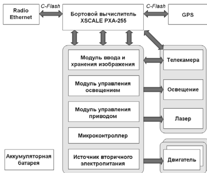
Рис.1. Структурная схема комплекса аппаратных средств ИСУ АММР
