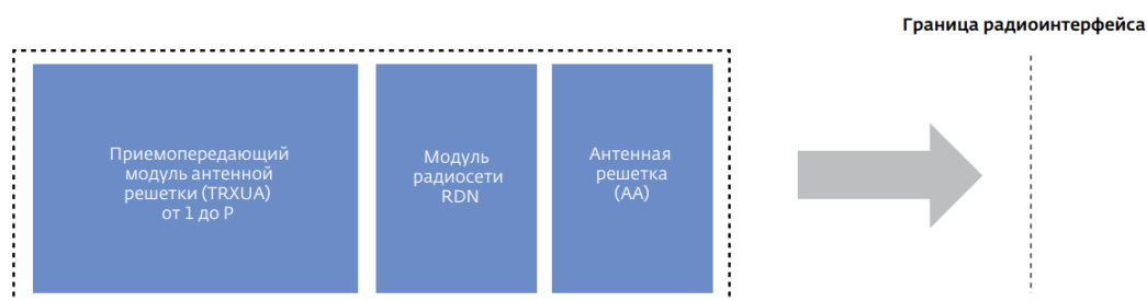
Рис. 5. Структура базовой станции 1-О и 2-О
