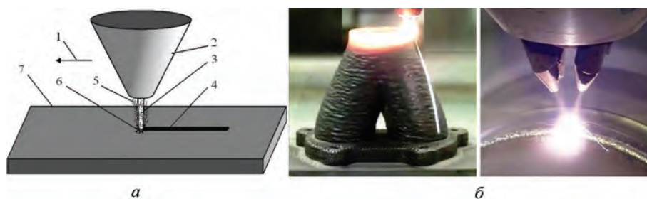
Рис. 3. Способ 3D-печати металлоизделий: а – принципиальная схема [9] (1 – направление движения; 2 – сопло осадителя; 3 – пучок лучей лазера; 4 – осажденный слой; 5 – частицы порошка; 6 – зона расплава; 7 – подложка); б – примеры выполнения
