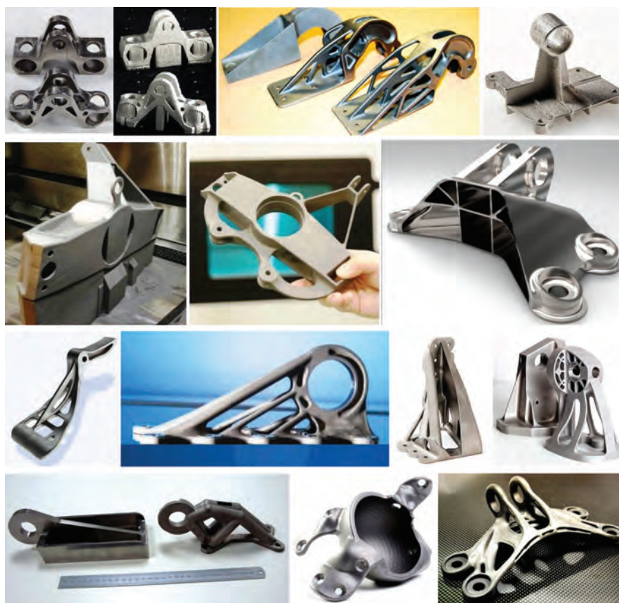
Рис. 4. Варианты 3D-печати различных кронштейнов
