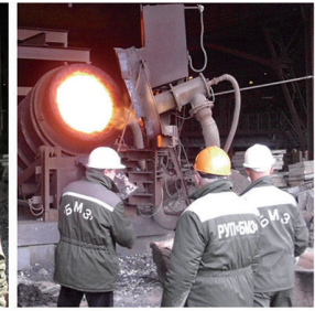
Восстановительная плавка прокатной окалины (Белорусский металлургический завод, 2010г.)
